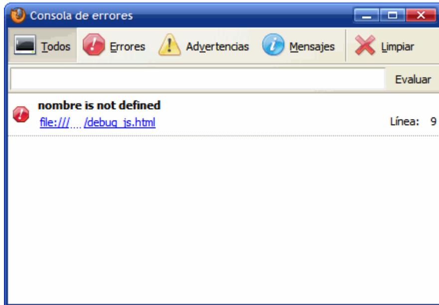
Figura 9.4. Consola de errores de Firefox donde se muestra toda la información sobre los errores de JavaScript
