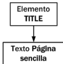
Figura 5.2. Nodos generados automáticamente por DOM para una etiqueta XHTML sencilla
