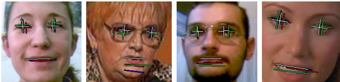
Figura 4.24: Ejemplos de imprecisiones de localización sobre la base UMU. Se representan las posiciones resultantes del método basado en integrales proyectivas (en blanco), en redes neuronales (en verde), en autoespacios (en azul) y en búsqueda de patrones (en rojo). De izquierda a derecha, se muestran extractos de: 17.jpg, c451.jpg, 29.jpg y 1035.avi.jpg.
