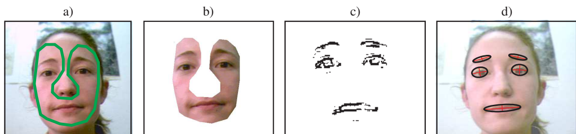
Figura 4.5: Localización y descripción de componentes faciales mediante agrupación de bordes en formas gaussianas [58]. a) Imagen original con la cara detectada. b) Cara segmentada con una máscara de forma predefinida. c) Resultado del filtro de Prewitt umbralizado, sobre la cara segmentada. d) Agrupación de los bordes en nubes de distribución gaussiana.
