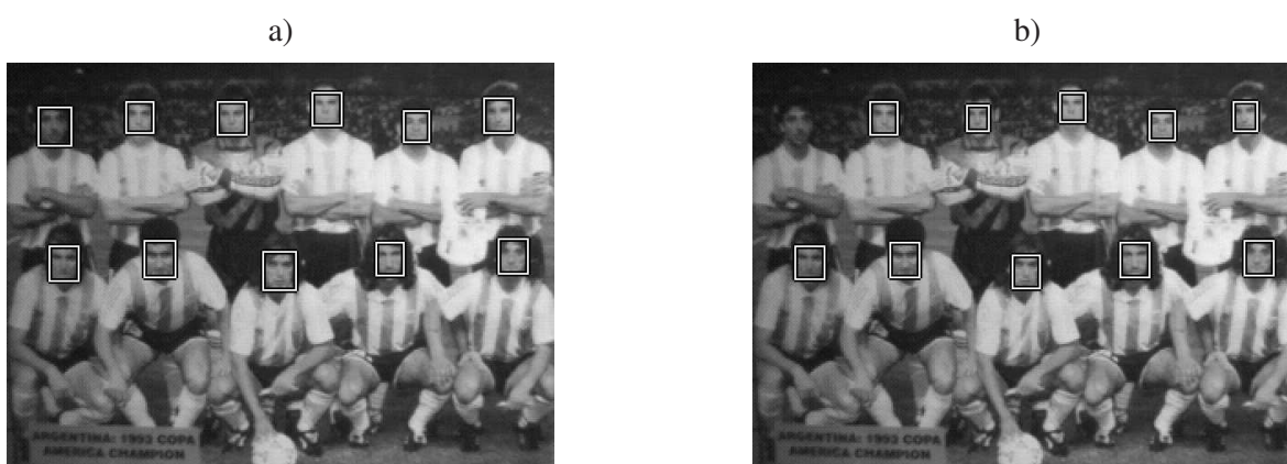
Figura 3.31: Comparación de resultados de los métodos de detección combinados, sobre la imagen Argentina.gif (CMU/MIT). a) Detector de Haar verificado con integrales proyectivas (tiempo de ejecución: 585 ms). b) Detector de proyecciones verificado con detector de Haar (tiempo de ejecución: 212 ms). Tiempos medidos sobre un Pentium IV a 2,6GHz.
