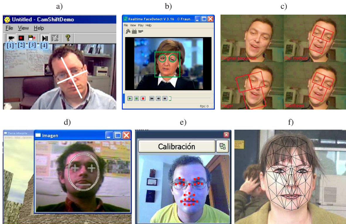
Figura 5.2: Distintos modelos para el seguimiento de caras, cada uno con una información diferente. a) Seguimiento mediante el algoritmo CamShift [35] (elipse contenedora de la cara). b) Real-Time FaceDetect Demo [53] (posición global de la cara, sin estimación de la inclinación). c) Seguimiento basado en apariencia [20, 19] (rectángulos de ojos y boca). d) Seguimiento en el interface perceptual “Tierra Inhospita” [61] (posición central de ojos y boca). e) Software de seguimiento de caras del sistema Orbit-Cam de Creative Labs Ltd. (seguimiento de 22 puntos clave). f) Seguimiento con sistemas de partículas [1, 44] (modelo de malla 3D deformable).
