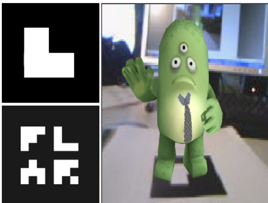
Figura 1.5. Ejemplos de los marcadores artificiales propuestos por Reitmayer.
