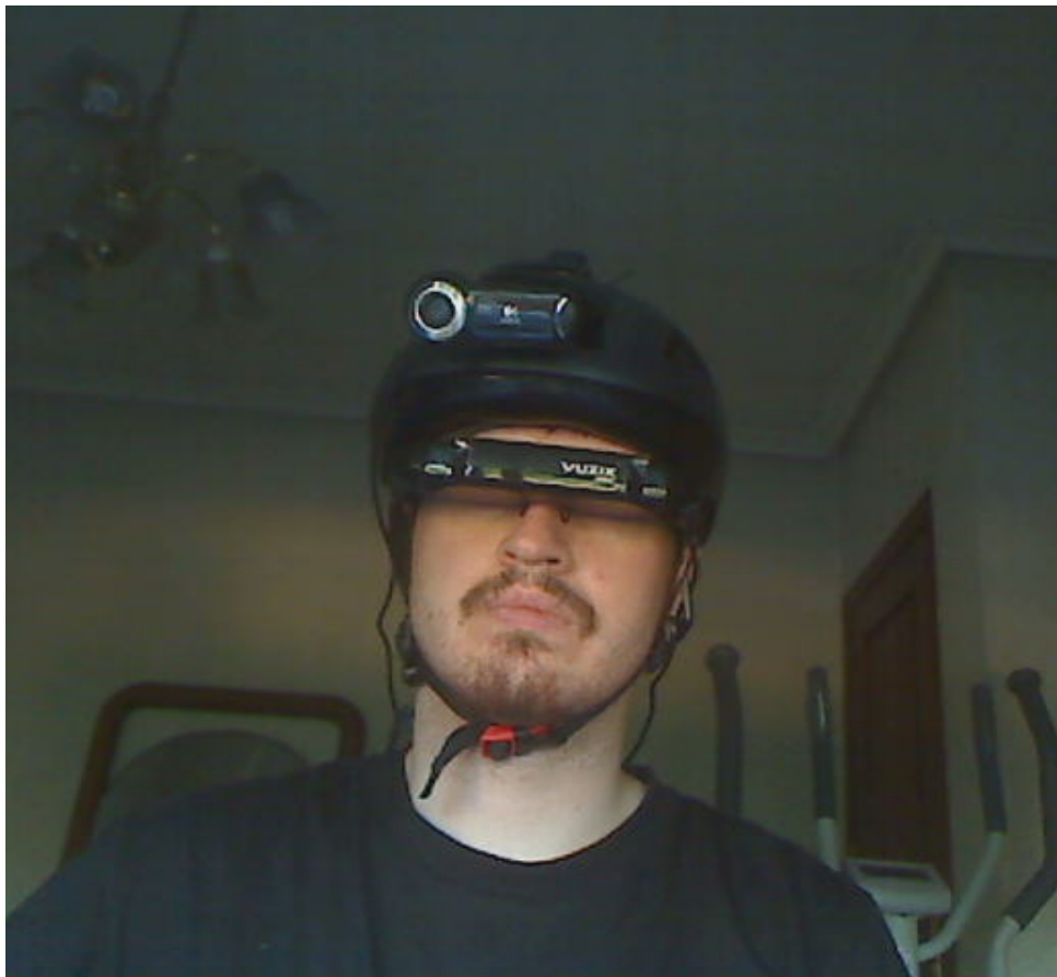
Figura 3.4. Ejemplo de dispositivo HMD casero.
