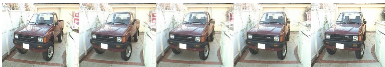
Fig 1.3: En esta imagen se muestran cinco vistas de una misma escena. Las dos laterales son imágenes reales y las tres centrales han sido obtenidas a partir de la información de correspondencia densa entre las otras dos.
