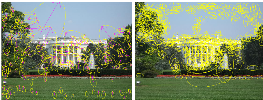
Figura 5.10: Resultado de aplicar los algoritmos SIFT y SURF sobre una misma imagen.
