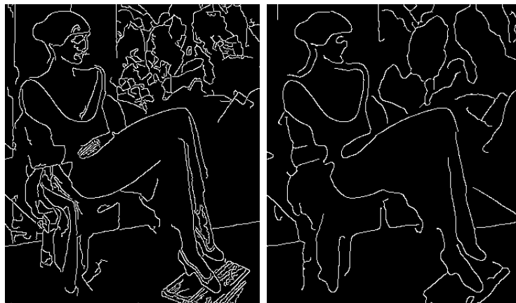
Figura 3.11: Resultado del algoritmo de detección de bordes de Canny con diferentes umbrales. En la imagen de la derecha se ha aplicado un umbral más restrictivo que en la izquierda.
