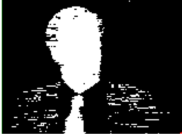
Fig. 27. Imagen resultado de efectuar el test de aceptación (un intervalo de aceptación para cada componente del canal HSI). En blanco se muestra los píxeles que superan el test y en negro los que no superan dicho test.
