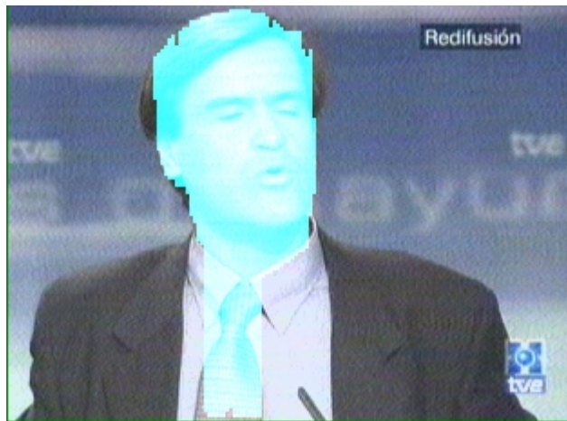
Fig. 28. Resultado obtenido tras lanzar tantos rayos verticales como de ancho es la imagen y con el parámetro 'seguidos=10'. Nótese cómo se ha filtrado el ruido producido por la binarización y cómo el conjunto de puntos marcados es convexo verticalmente.
