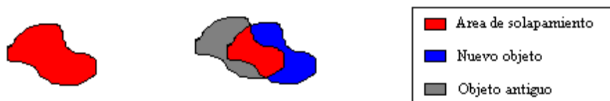
Fig. 19. De izquierda a derecha. 1.- Solapamiento total de un objeto con su relacionado, aquí la distancia es cero. 2.- Solapamiento parcial de un objeto, aquí la distancia es el área de la zona color gris que es la parte del objeto antiguo que no ha sido cubierta por el nuevo.
