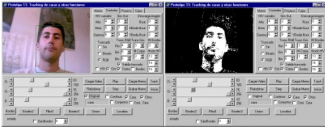
Fig. 30. Imagen original en penumbra y con luz natural, antes y después de la segmentación. En este caso hay algo de ruido y es posible que no se localiza bien el contorno de la cara.
