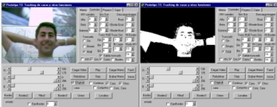
Fig. 32. Imagen original su segmentada. En este caso no se puede segmentar la cara de las manos y es por ello que se trata como un objeto único, lo que induce a error al sistema de seguimiento.
