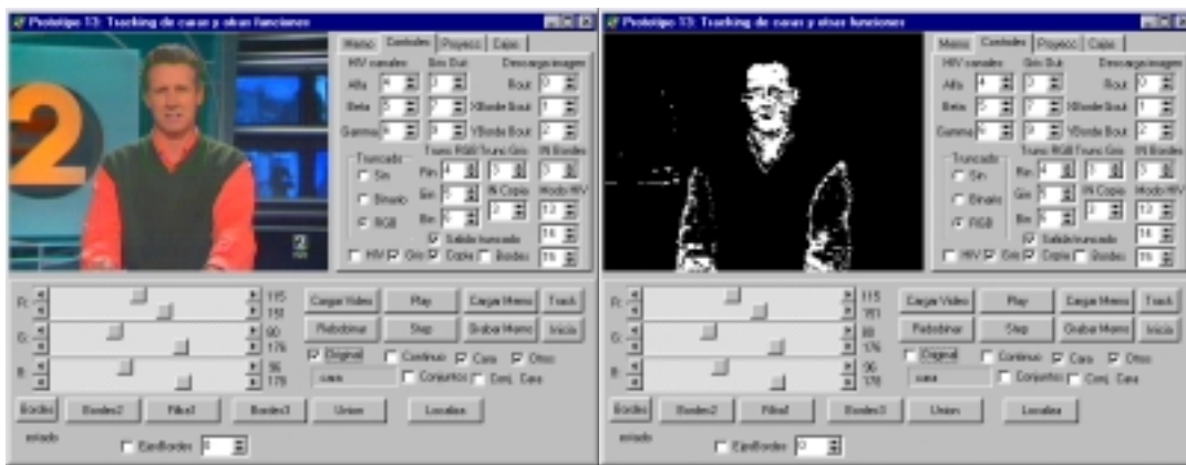
Fig. 31. Imagen capturada de la televisión y su posterior segmentación. Este es un caso donde, debido al color de la camisa y al número 2, es muy difícil realizar una buena segmentación. Es por ello que aparecen nuevas componentes, por lo tanto, el subproceso de asignación deberá identificar la componente correcta asignada a la cara.
