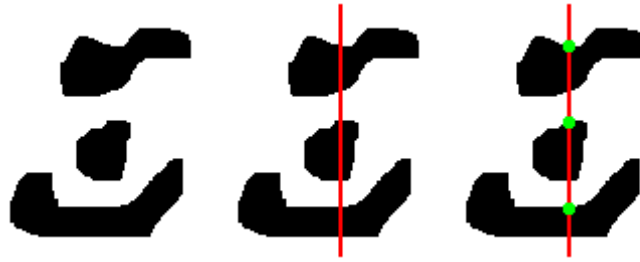
Fig. 23. De izquierda a derecha. 1.- Tres componentes binarizadas (en negro), 2.- Se lanza un rayo vertical (en rojo), 3.- Colisión del rayo con los objetos: resultado de lanzar el rayo (en verde).
