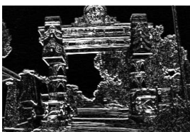
Valor absoluto de derivada en Y (Sobel de 3x3)
