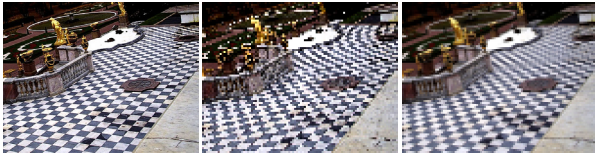
Imagen original 500x386 Reducción de 5x con interpolación bilineal Reducción de 5x con supermuestreo
